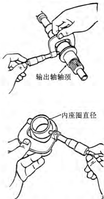
图 44 检查轴和内座圈的直径
